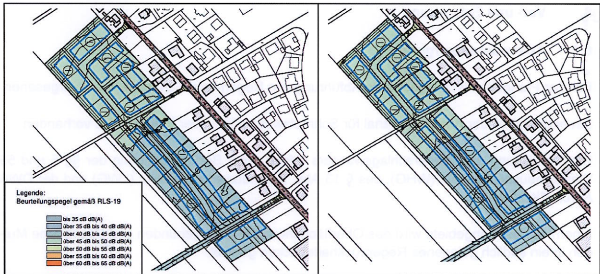
Abb. 9 u. 10: Farbige Rasterlärnkarte Nacht-Situation - links 1. OG, rechts 2.OG (Auszug aus dem schalltechnischen Prognosegutachten von Graner + Partner – unmaßstäblich)
